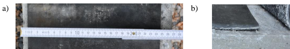
Rys. 10. Badania wymiarowe gotowego podkładu kolejowego z podkładką podpodkładową: a) zróżnicowana odległość krawędzi podkładki podpodkładowej od krawędzi spodu podkładu; b) strefa braku przyczepności na połączeniu pomiędzy podkładką podpodkładową, a podkładem - w środkowej części podkładu
