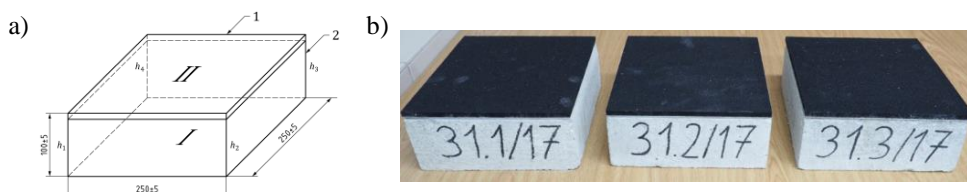
Rys. 11. Próbkę podkładki podpodkładowej przymocowanej do kostki betonowej o wymiarach 250 x 250 x 100 mm do badania statycznego i dynamicznego modułu sztywności podkładki zgodnie z normą PN-EN 16730 [12]: a) schemat wymiarowy wraz z tolerancjami wykonania (oznaczenia: 1 – podkładka podpodkładowa; 2 – kostka betonowa); b) próbki z podkładką podpodkładową na bazie granulatu gumowego o gr. 9 mm przed badaniami (3 szt.)
