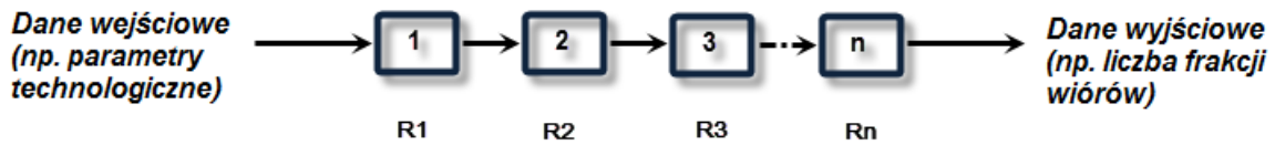
Rys.1. Przykład struktury niezawodnościowej obiektu technicznego (maszyny technologicznej) w układzie szeregowym ( R_1 \div R_n – niezawodność wszystkich elementów szeregu) [13]
