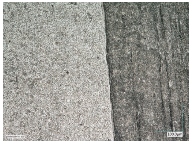
Rys. 6. Mikrostruktura złącza zgrzewanego różnoimiennej pomiędzy stalą B500B i 1.4021; po lewej stronie mikrostruktura stali zbrojeniewej B500B, po prawej struktura stali martenzytycznej z wyraźną włóknistością; mikrostruktura w stanie wyjściowym przed rozciąganiem [fot. M. Ostromęcka]
