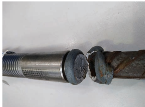
Rys. 10. Przekrój w zgrzeinie w próbce B23.4/21 [fot. M. Ostromęcka]
