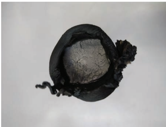
Rys. 8. Przekrój w zgrzeinie w próbce B22.5/21 [fot. M. Ostromęcka]
