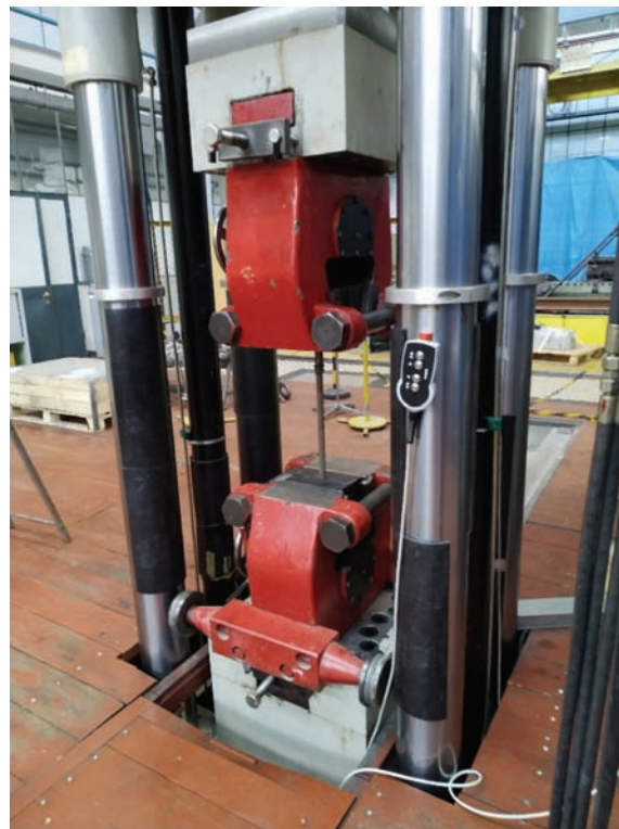
Rys. 4. Stanowisko badawcze – maszyna wytrzymałościowa [fot. M. Ostromecka]
