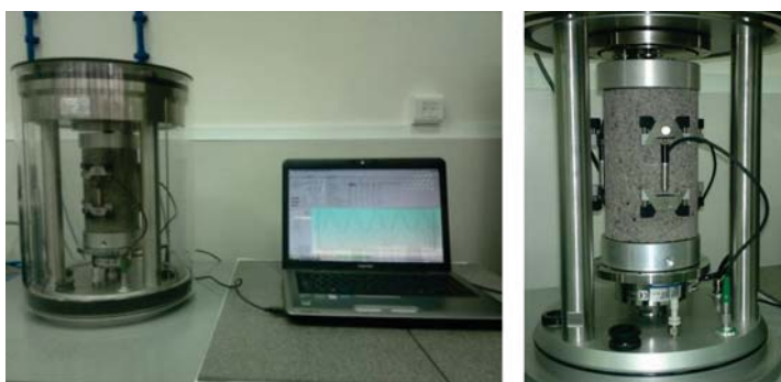
Rys. 2. Widok próbki podczas badania w urządzeniu Simple Performance Tester (SPT)
