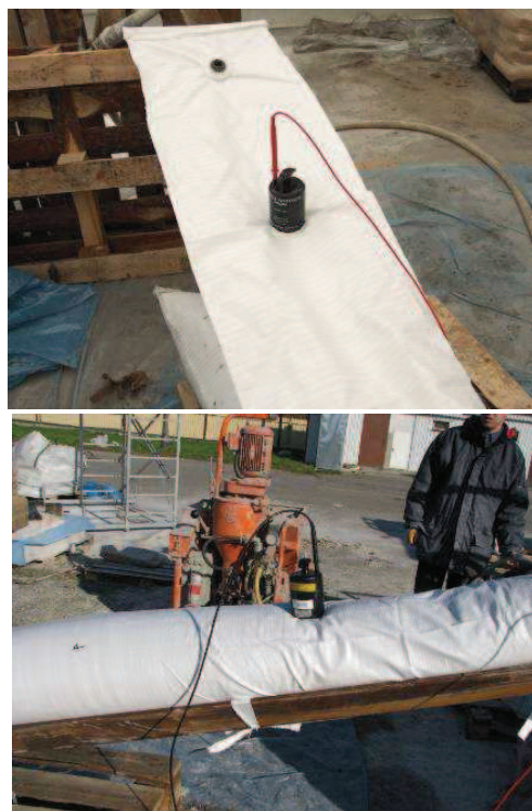
Rys. 16. Badania tkaniny polipropylenowej z przeplotem metalowym [13]
