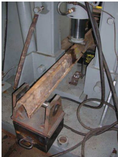
Rys.5. Badania kształtownika stojaka ciernego w stanowisku do badań zaworów [10]
