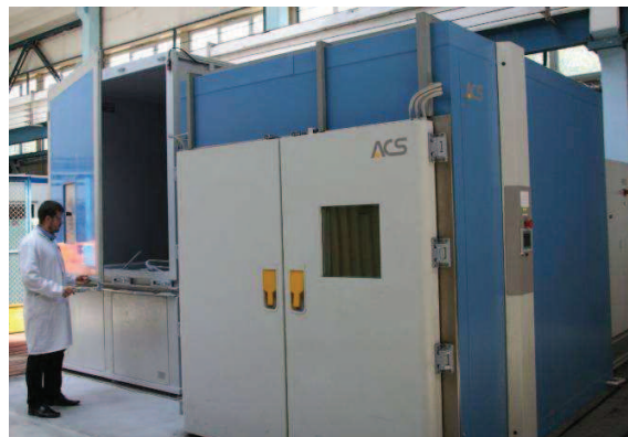
Rys.12. Komora pyłowa i klimatyczna [13]
