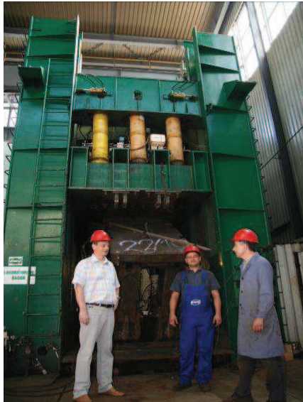
Rys.1. Stanowisko do badań wytrzymałości sekcji obudowy zmechanizowanej [10]
