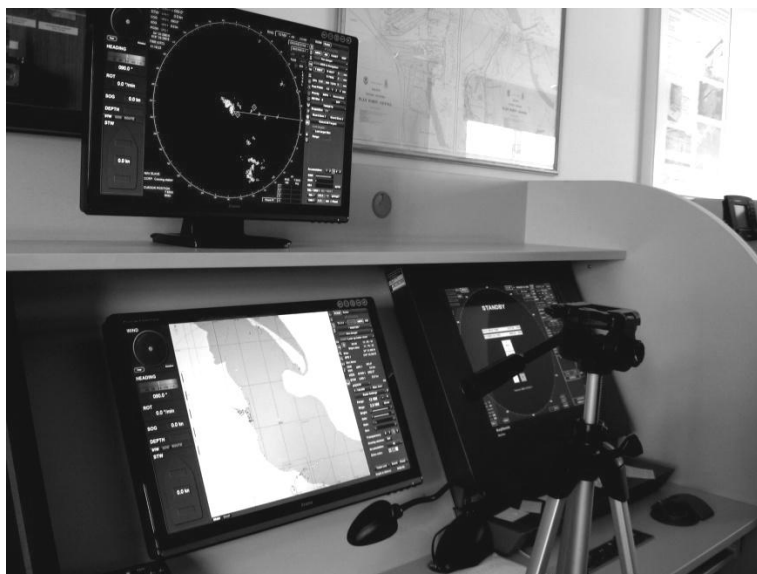
Rys. 4. Stanowisko do prezentacji na ECDIS zobrażenia radarowego uzyskanego z badanego radaru FM-CW CRM-203
