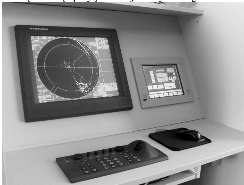
Rys. 3. Konsola radaru FM-CW CRM-203 (po lewej stronie ekran radarowy, po prawej stronie pulpit ustawień radaru)
