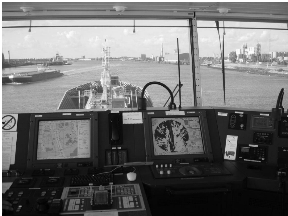
Fot. 2. Monitory systemu nawigacji zintegrowanej zainstalowane na mostku nawigacyjnym statku morskiego
