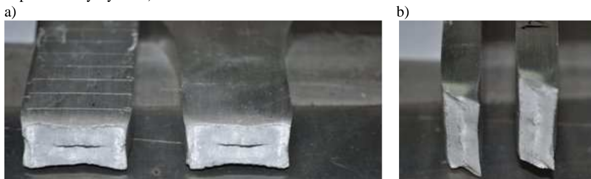
Rys. 3. Przełomy próbek połączenia tarcowego stopu 7020: a) z wadą , b) bez wady
