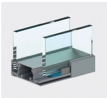
Rys. 2. Przekrój ściany działowej, szklanej Alufire Neo Office +Line [3,4]
