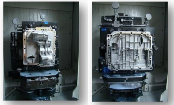
Rys.5. Część zamocowania do obróbki na centrum obróbkowym A i B DMG: a) zamocowanie 1; b) zamocowanie 2
