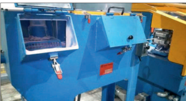
Rys. 5. Skrzynka smarowa linii dużej
