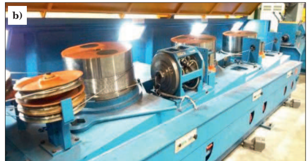
Rys. 6. Część odkształcająca linii ciągarskich: dużej – dwubębnowa (a) i małej – trzybębnowa (b)
