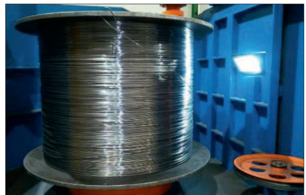
Rys. 7. Zwijarka gotowego drutu na szpule wraz z układaczem drutu na szpuli
