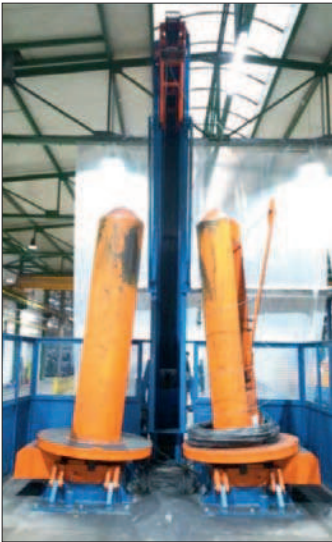
Rys. 2. Dwa rozwijaki oraz wieża rozwijaków linii dużej
