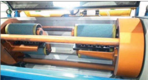
Rys. 4. Urządzenie do doczyszczania powierzchni walcówki papierem ściernym linii dużej
