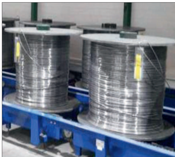
Rys. 12. Przykładowy drut z dostaw zewnętrznym (z lewej) i z własnej ciągnięcia firmy Legipol (z prawej)
