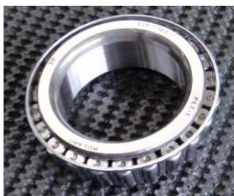
Rys. 1. Złożenie łożyskowe łożyska stożkowego przed operacją mycia.
