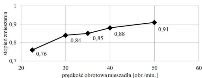
Rys. 6. Zmiany stopnia zmieszania w zależności od prędkości obrotowej mieszadła.
