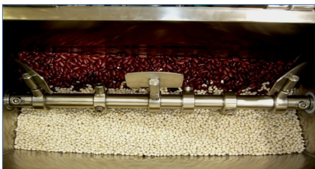
Rys. 2. Wnętrze aparatu przed rozpoczęciem mieszania
