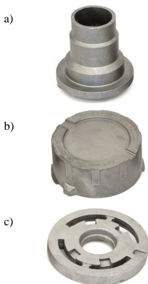
Rys. 7. Odlewy badane w aspekcie błędów kształtu: kołowości i płaskości
