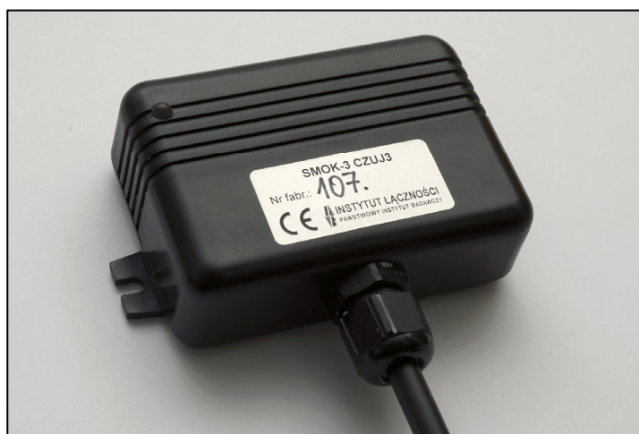
Rys. 17. Czujka zintegrowana z czujnikiem kontaktronowym
