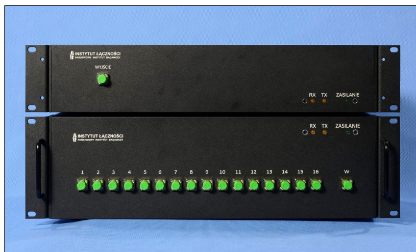
Rys. 21. GP do kabli światłowodowych (na górze) i przełącznik światłowodów 1:16 (na dole)
