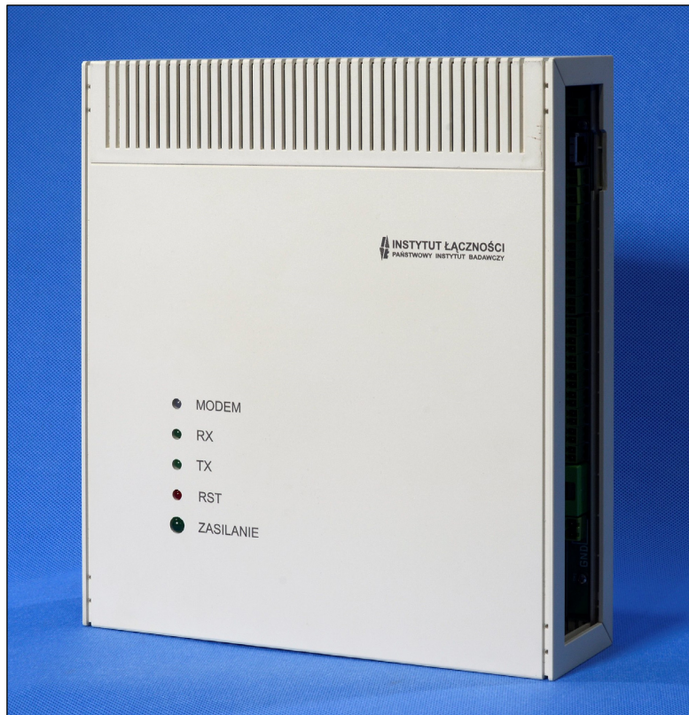
Rys. 15. Głowica pomiarowa do kabli miedzianych i obsługi czujek
