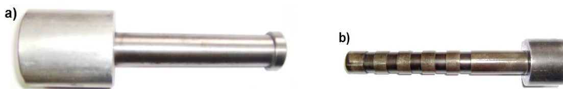
Rys. 5. Użyty granat nasadkowy (a) oraz montowana na wylocie lufy nasadka (b) Fig. 5. Rifle grenade (a) and the adapter cap (b)
