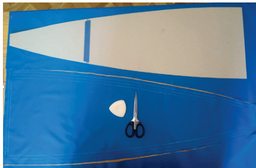
Rys. 11. Przygotowanie segmentu spadochronu z wykorzystaniem szablonu
