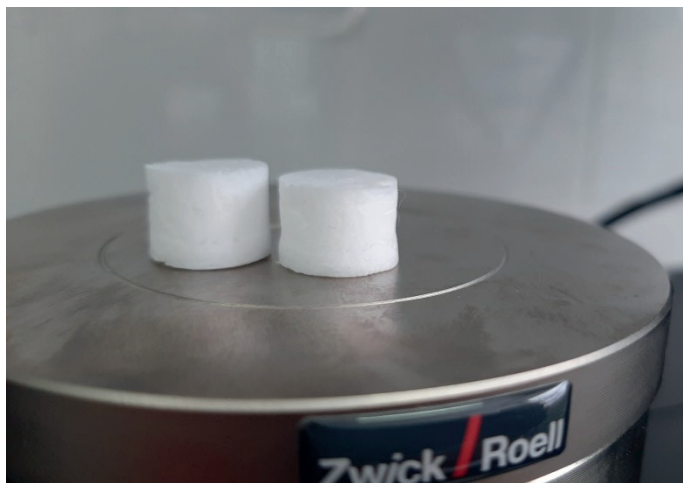
Rys. 3. Próbką przed i po badaniu wytrzymałości na ściskanie
