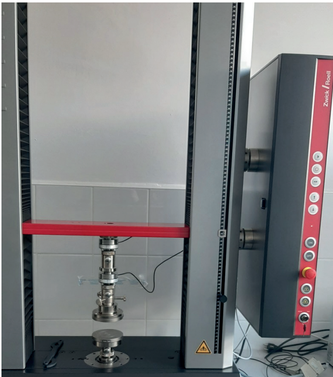
Rys. 2. Maszyna wytrzymałościowa – pomiar wytrzymałości na ściskanie
