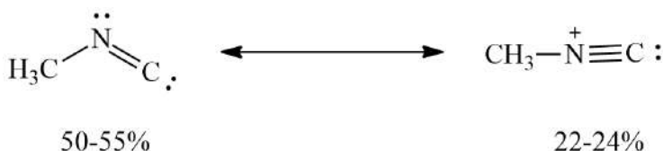
Rysunek 3. Dwie najważniejsze struktury rezonansowe jakie przyjmują izocyjanki Figure 3. Two most important resonance forms of isocyanide
