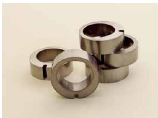
Rys. 3. Zdjęcia próbek przygotowanych do badań: a) próbki typu klin; b) próbki typu pierścieni krzywkowych
