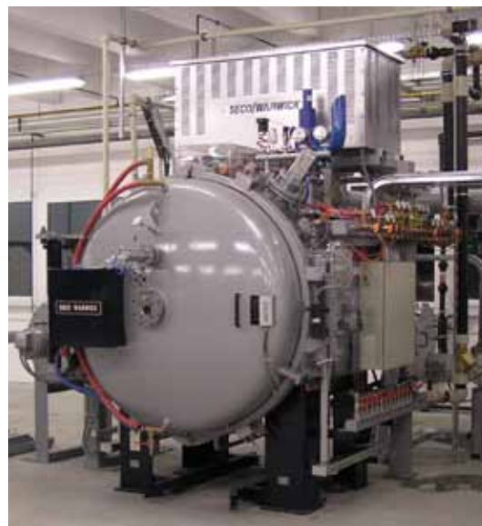
Rys. 2. Przemysłowy piec próżniowy typu VPT firmy Seco/Warwick
