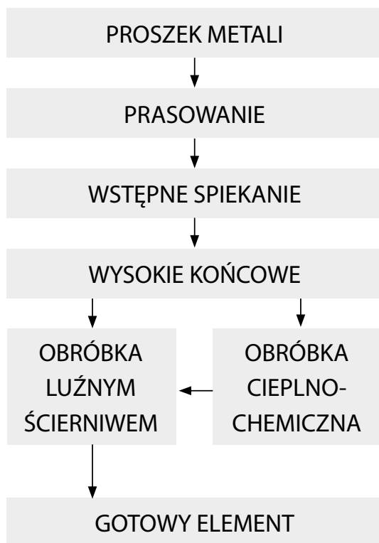
Rys. 1. Technologia wytwarzania wyrobów z proszków spiekanych w jednej operacji kształtowania plastycznego
