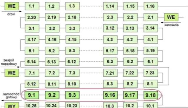
Rys. 2. Uproszczony schemat linii montażowej w analizowanym przedsiębiorstwie motoryzacyjnym. Źródło: opracowanie własne.
