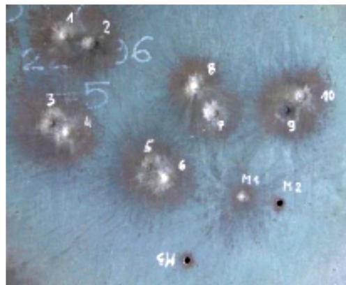
Rys. 7. Fotografia miejsc ostrzału blachy o grubości 5,8 mm pociskiem NATO Ball i M193 (wariant 225/96)
