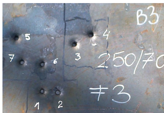
Rys. 5. Fotografia miejsc przebitcia blach o grubości nominalnej 3,0 mm pociskiem kal. 7,62 × 39 mm PS (wariant 250/70)
