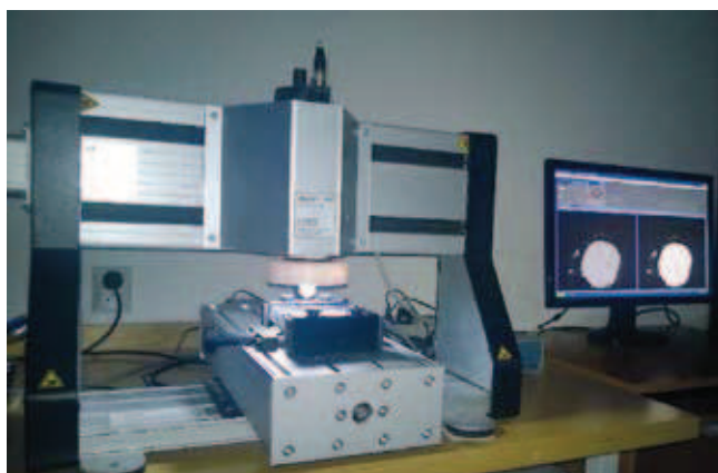
Rys. 1. RapidAir 457 – aparatura do badania charakterystyki porów powietrznych w betonie
