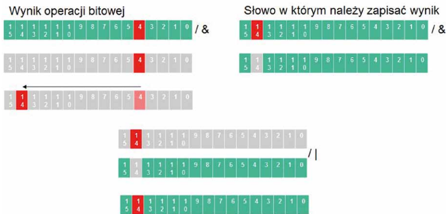
Rys. 5. Zapis bitu wynikowego do właściwego słowa w pamięci
