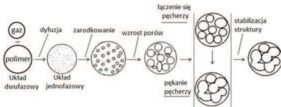
Rys. 4. Schemat powstawania pianek mikrokomórkowych [23]
