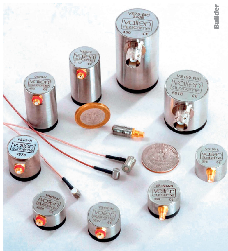
Rys. 10. Przykładowe czujniki wykorzystywane w metodzie emisji akustycznej [M11]
