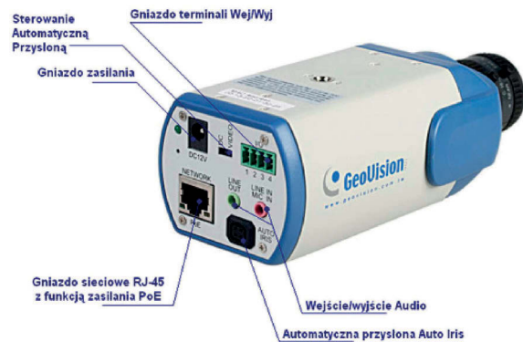
Rys. 8. Przykładowa kamera sieciowa IP [M8]
