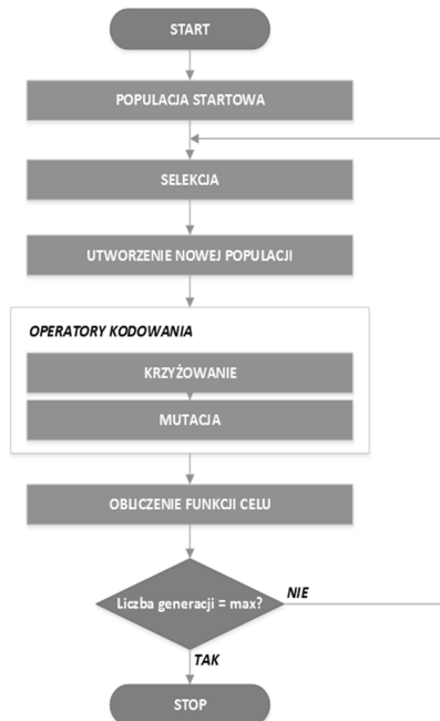
Rys. 2. Schemat blokowy algorytmu genetycznego
