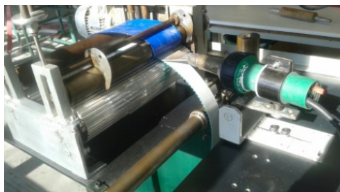
Maszyna do pokrywania pasów zębatych; na grzbiet pasa pod wpływem gorącego powietrza наносzona jest warstwa PU za pomocą ekstrudera ręcznego
