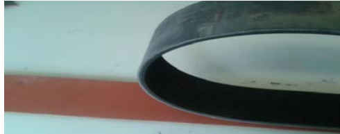
Pas zębaty oraz materiał наносzony na grzbiet pasa podczas sklejania
