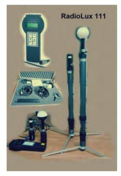
Fig. 1. Photometer RadioLux 111
