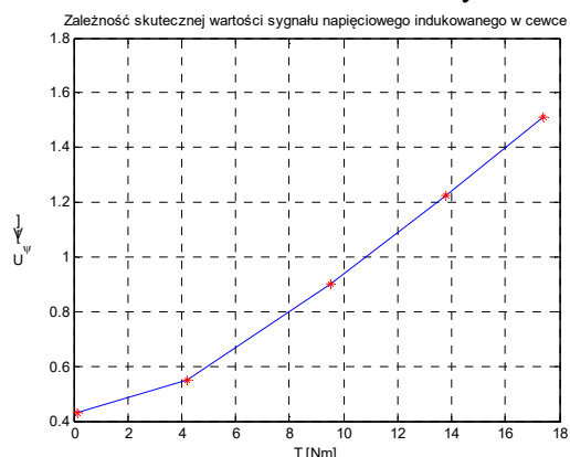
Rys. 7. Zależność zmierzonego napięcia indukowanego w cewce od momentu – silnik symetryczny
