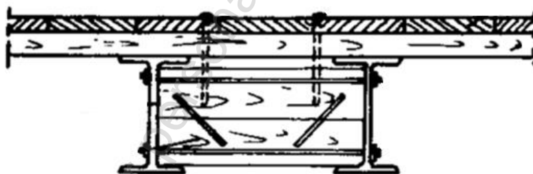
Rys. 2. Ześrubowane pakiety przęsła złożone z dwuteowników stalowych
