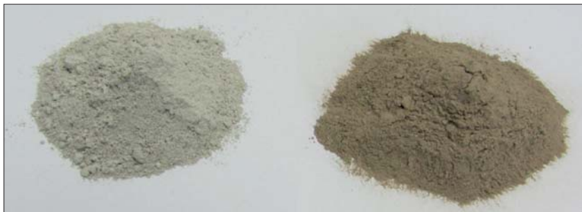
Fot. 4. Porównanie barwy wypełniacza stosowanego do produkcji i wypełniacza odzyskanego w procesie ekstrakcji (fot. P. Przedpełski)
