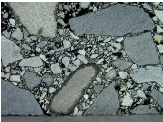
Fot. 3. Absorpcja lepiszcza przez kruszywo w mma (fot. J. Boratyński)
