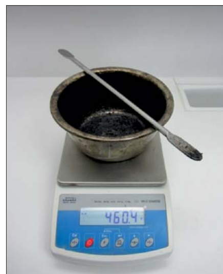
Fot. 8. Masa miski i szpatułki po usunięciu próbki mma (fot. P. Przedpeński)
