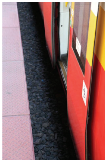
Rys. 4. Powiększona pozioma odległość mierzona pomiędzy krawędzią peronu a stopniem pojazdu w przypadku skrajni 1 WM [14]
