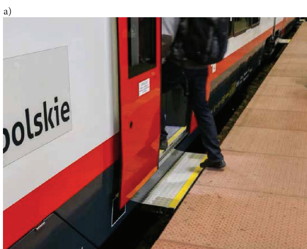
Rys. 20. Przesłona luki [39]: a) wysuwana, b) obracana
