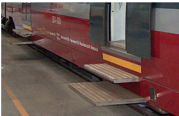
Rys. 19. Pojazd typu ED74 z wysuniętymi stopniami [29]
