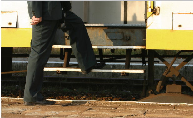
Rys. 6. Podłoga wagonu powyżej krawędzi peronu [fot. P. Gonddek]
