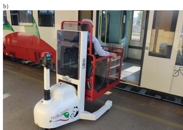
Rys. 15. Podnośnik PANDA STATION [24]: a) widok podnośnika, b) wykorzystanie podnośnika
