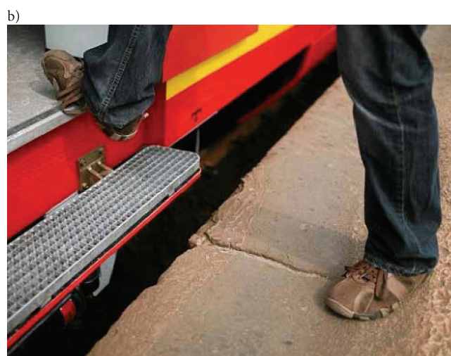
Rys. 20. Przesłona luki [39]: a) wysuwana, b) obracana
