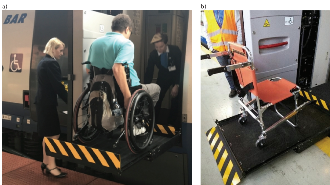
Rys. 16. Podnośnik montowany przy drzwiach wagonu: a) podczas podnoszenia podróżnego na wózk inwalidzkim [22], b) krzeselko na podnośniku dla osób o ograniczonych możliwościach ruchowych, nie poruszających się na wózkach inwalidzkich [23]
