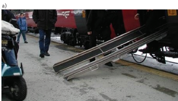
Rys. 21. Rynny zjazdowe: a) na kolejkach szwedzkich [25], b) na kolejkach niemieckich [26]
