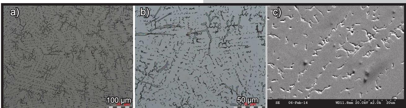
RYS. 3. Mikrostruktura stopu CombiBond BST Triumph: a) obraz wykonany przy wykorzystaniu mikroskopii świetlnej pow. 200x, b) obraz wykonany przy wykorzystaniu mikroskopii świetlnej pow. 500x, c) obraz wykonany przy pomocy SEM.
