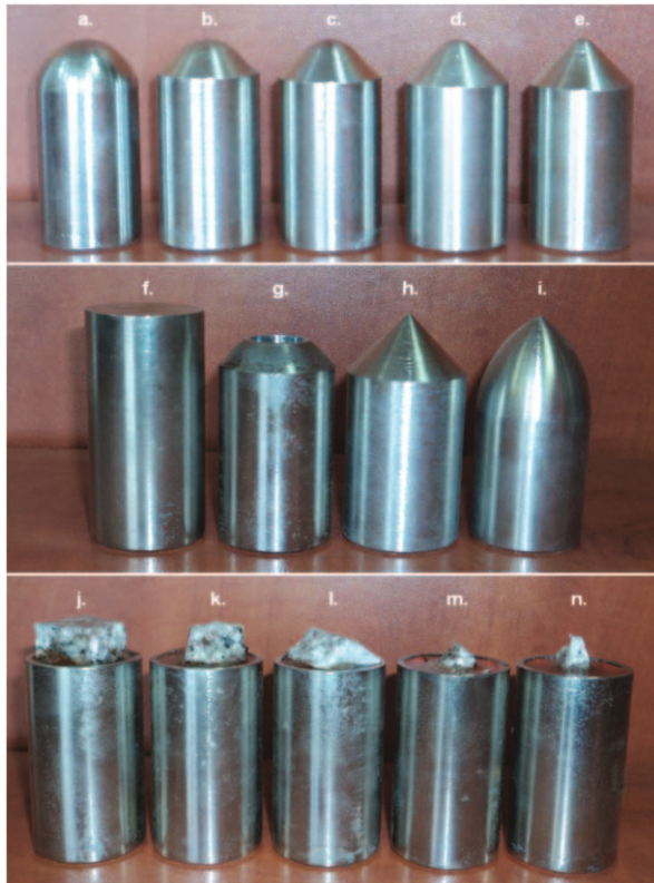
Rysunek 2 Impaktory z zaokrągloną końcówką: a. R17, b. R14, c. R11, d. R8, e. R5 mm; impaktory: f. z płaską końcówką \varnothing 34 mm, g. z płaską końcówką \varnothing 19 mm, h. z końcówką stożkową, i. z końcówką ostrołukową; impaktory z wtopionymi kamieniami: j. z płaską powierzchnią uderzenia, k. z chropowatą powierzchnią uderzenia, l. z żebrzem kamienia uderzającego, m. z wierzchołkiem kamienia uderzającego, n. z wierzchołkiem kamienia uderzającego umieszczonym pod kątem
