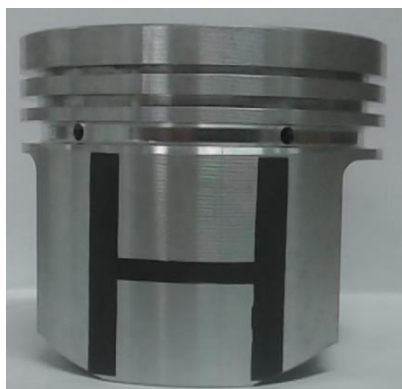
Rys. 3. Tłok z naniesioną warstwą grafitu na powierzchni nośnej w kształcie litery H
