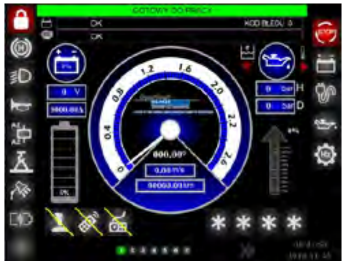
Rys.7 Synoptyka parametrów pracy ciągnika typu CA-190
