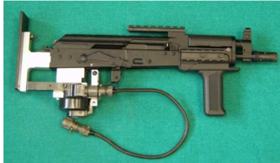
Fot .1. Subkarabinek wz. 1996 „Mini Beryl” przygotowany do zamocowania na stanowisku badawczym
