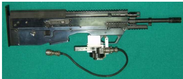
Fot. 3. Karabinek B-01 MSBS-5,56 w układzie bezkolbowym, przygotowany do zamocowania na stanowisku badawczym
