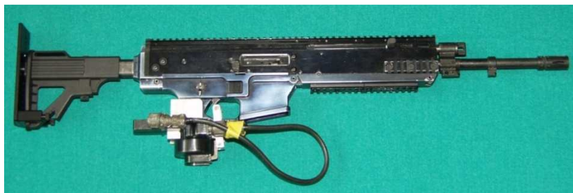
Fot. 2. Karabinek MSBS-5,56 K-01 w układzie klasycznym, przygotowany do zamocowania na stanowisku badawczym
