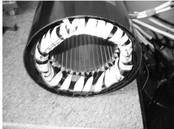
Rys.14. Widok uzwojonego stojana silnika BLDC
