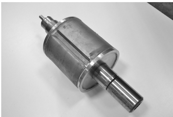
Rys.13. Widok wykonanego wirnika silnika BLDC
