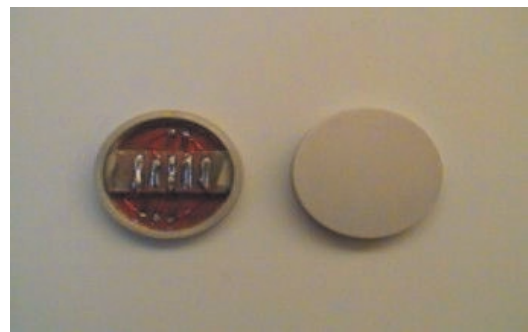
Rys. 4. Przykładowy czujnik naporu do pomiarów w materiałach rozdrobnionych Fig. 4. A strain gage transducer for stress measurements in granular materials
