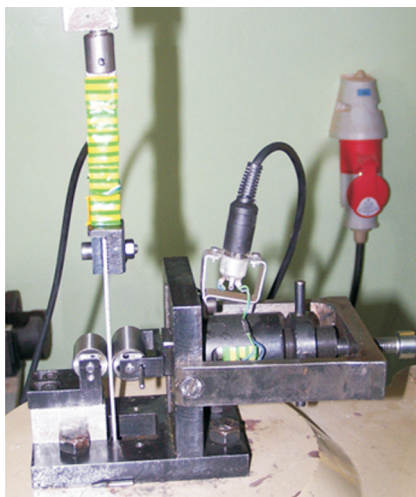
Rys. 5. Przyrząd do badania oporów tarcia w próbie przeciągania pasa blachy
