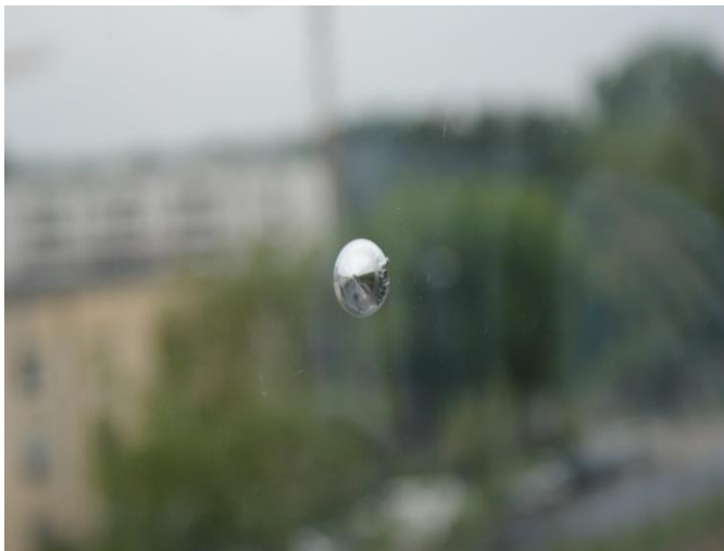
Rys. 6. Odprysk szkła charakterystyczny dla wtrąceń niklu
