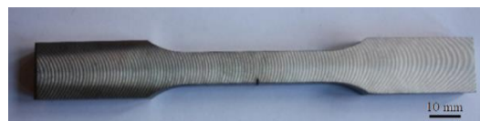
Rys. 3. Zdjęcie próbki o najbardziej ostrym karbie. Szerokość próbki wynosi 140 mm
