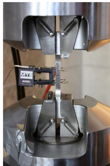
Rys. 2. Próbką testową w szczękach maszyny wytrzymałościowej MTS810
