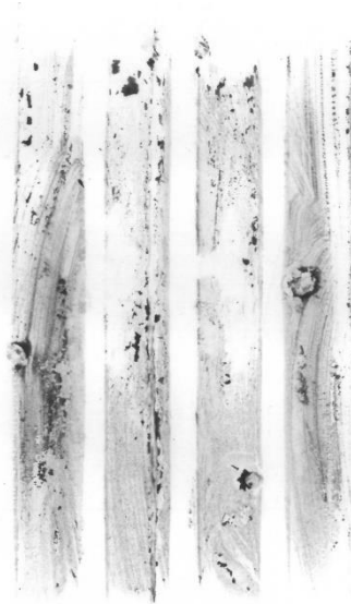
Rys. 2. Negatyw powierzchni styku koło–nawierzchnia dla opony T520
