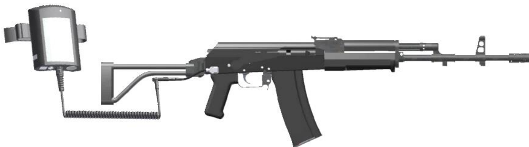
Rys. 5. MKB podłączone do symulatora karabinu Beryl
