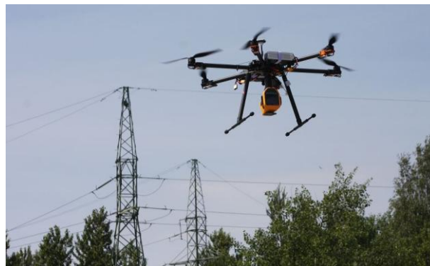
Rys. 8. Diagnostyka sieci elektroenergetycznej przez dron [16]
