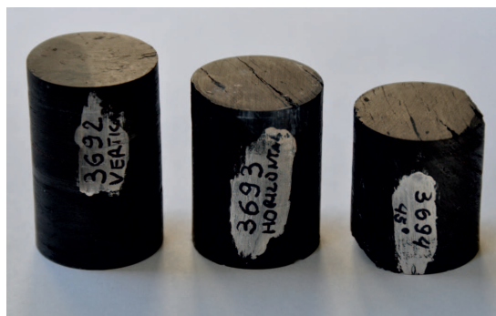
Rys. 2. Rdzenieki z węgla kamiennego użyte do badań po obróbce powierzchni czołowych. Na próbce 3693 oraz 3694 widoczne spękania równoległe do uwarstwienia
