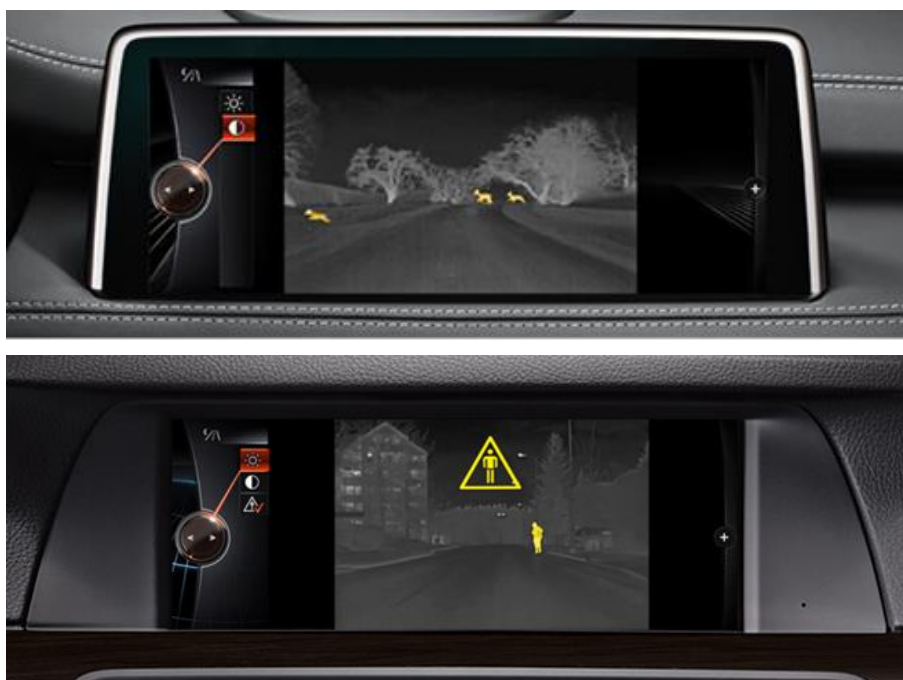
Rys. 9. Przykład sygnalizowania rozpoznawania zwierząt i ludzi przez system noktowizji w pojazdach firmy BMW (rys. www.bmw.pl )
