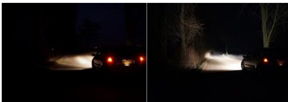
Rys. 4. Porównanie oświetlenia drogi dla światel mijania i sportowych (rys. Krzysztof Stryjek) Fig. 4 Comparison of road illumination for the low beam and sport lights (Fig. Krzysztof Stryjek)
