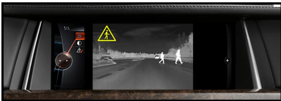
Rys. 11. Widok rozpoznanych pieszych w systemie Night Vision BMW (rys BMW Polska) Fig. 11. View of diagnosed pedestrians in the BMW Night Vision system (Fig BMW Poland)
