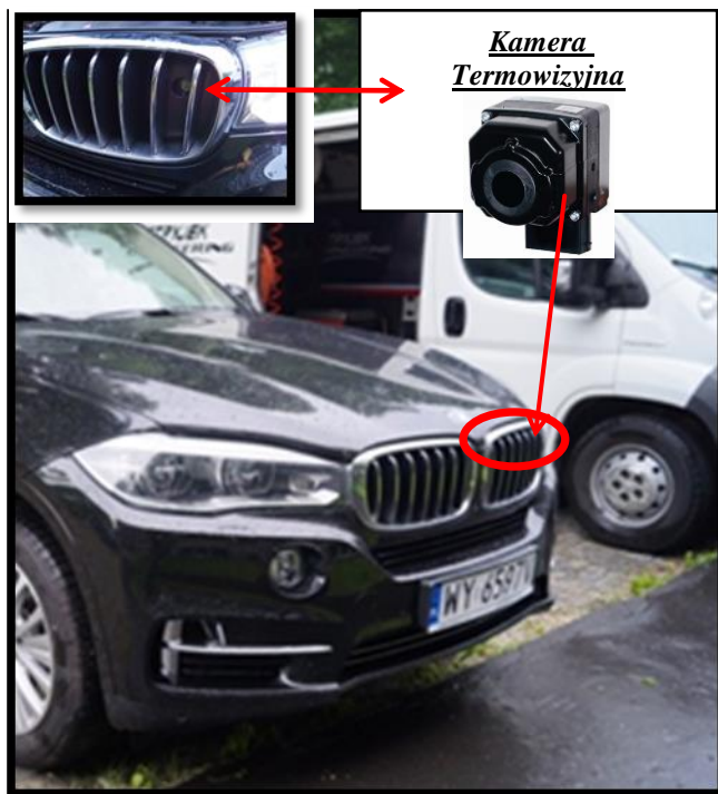
Rys. 10. Rozmieszczenie kamery termowizyjnej w pojeździe (rys. Grzegorz Motrycz). Fig. 10. Arrangement of the infrared camera in the vehicle (fig. Grzegorz Motrycz).
