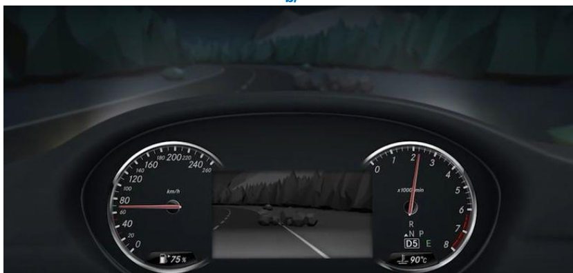
Rys. 8. Schemat dziania aktywnego systemu night view/vision (źródło Mercedes Benz). Fig. 8. Schematic of the active system, night view / vision (źródło Mercedes Benz).
