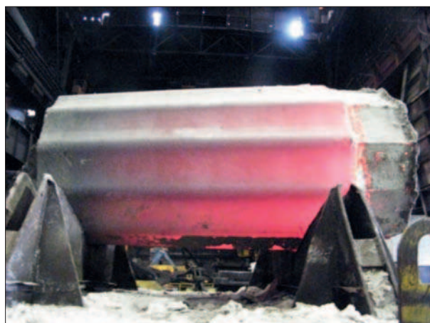
Rys. 10. Widok doświadczalnego wlewka o masie 11,4 t odlanego do uniwersalnej wlewnicy przed załadowaniem do pieca grzewczego w wydziale prasowni (wytop nr 36263, temp powierzchni: 792 (przy głowie), 712 (środek) i 691 (stopa), °C)
