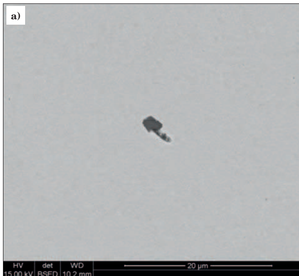
Rys. 13. Pojedyncze wtrącenia MgO \cdot Al_2O_3 w próbce z odlewki z okolic głowy wlewk o masie 14,5 t, a) kształt wtrącenia, b) skład chemiczny wtrącenia w % masowych
