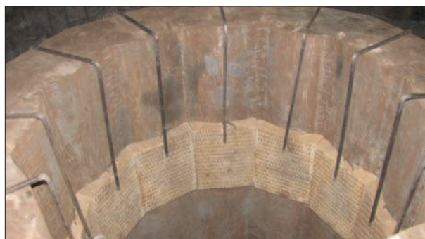
Rys. 9. Widok „z góry” uniwersalnej wlewnicy z umieszczonymi wewnątrz wkładkami izolacyjnymi, do odlania w niej wlewka o masie 11,4 t
