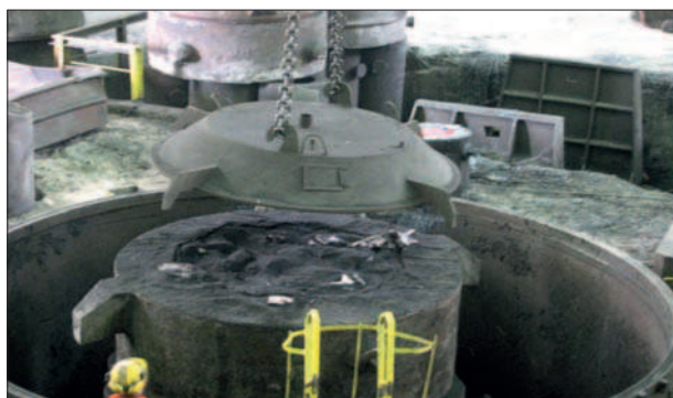
Rys. 4. Nakładanie pokrywy izotermicznej po odlaniu w komorze próżniowej wlewka o masie 100 t Fig. 4. Placement of iso-thermal cover after casting of 100 t ingot in vacuum chamber
