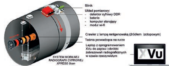
Rys. 2. Ogólny widok mobilnego systemu radiografii cyfrowej XPRESS Scan – 3Endt (skanera wraz z detektorem DDA) do badania złączy obwodowych rurociągów.
