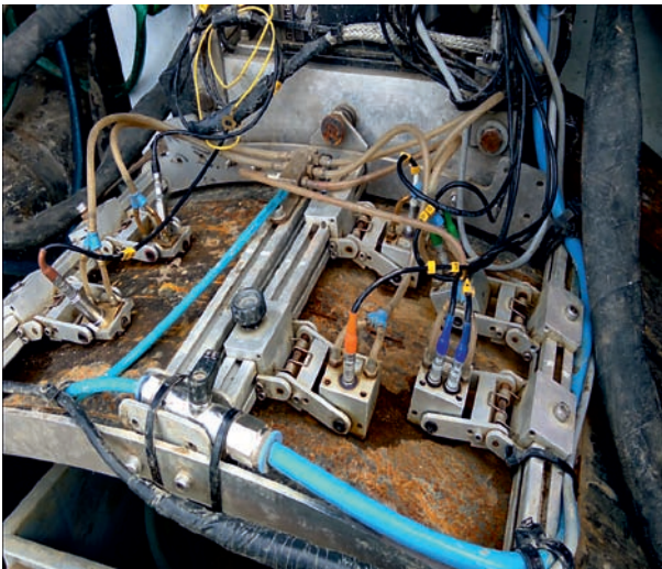
Rys. 4. Układ głowic skanera względem osi spoiny.
