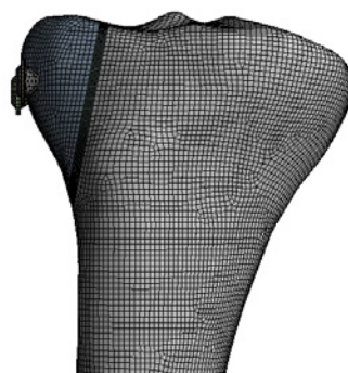
Rys. 2. Model geometryczny zespolenia złamania 4.1.B.1.1 za pomocą 2 śrub gąbczastych o średnicy 6,5 mm i skoku gwintu 2,45 mm
